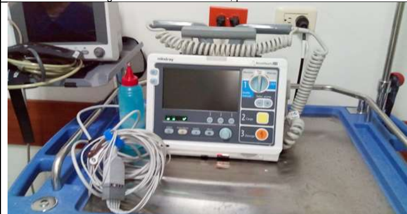
Foto 4. Desfibrilador mindray beneheart D3 con marca pasos pantalla 7" diseño 4 en 1
