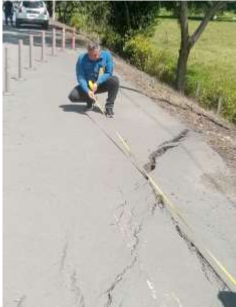
Mediciones del tramo de falla perfil del asentamiento presentado
